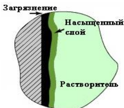
Рисунок 2. – Принцип химической очистки детали от загрязнения
