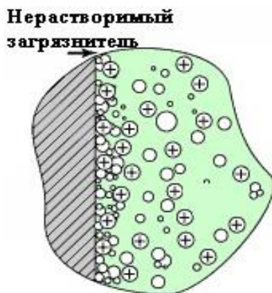
Рисунок 4. – Насыщение кавитационных пузырьков у загрязнения
