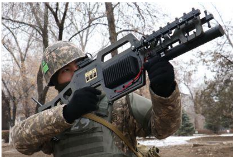
Рисунок 2. – Пример практического использования противодронного ружья, разработанного в ВИИРЭиС
